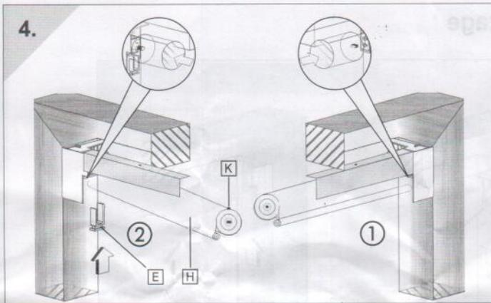
4. Rollo **H** ggf. kürzen (siehe nächstes Kapitel "Abmessungen anpassen"). Rollo zuerst in das Eckprofil rechts stecken. Darauf achten, dass der farbige Sicherungsstift **K** nach oben weist und ganz in die Öffnung hineingedrückt ist. Dann das andere Rolloende von unten in das Eckprofil links drücken und nach vorne einrasten. Die Rolloarretierung **E** unten in das Eckprofil links drücken.
